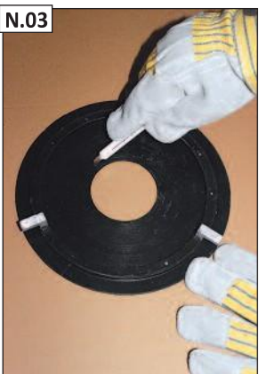
Išpjaukite vidinę angą reikiamam jungiamajam vamzdžiui.
