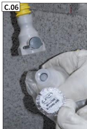
C.06 Nuo tuščio kondensato surinkimo maišelio adapterio jungties nuimkite plombą.
